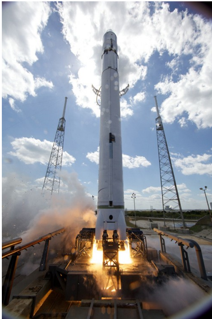
Falcon 9 : 13.3.2010: zkušební zážeh (3,5 s)
