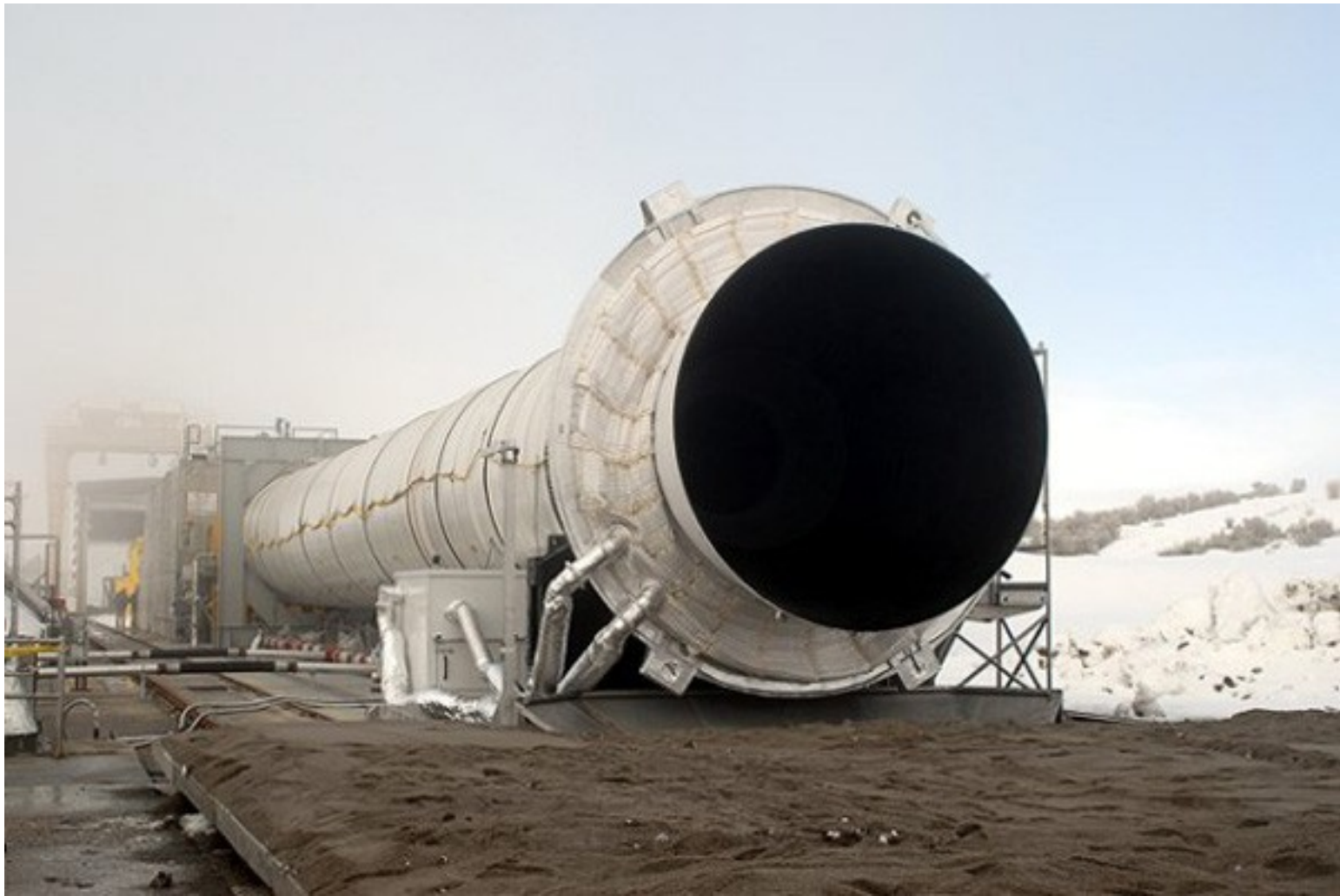
Birgham City, Utah: Příprava SRB raketoplánu (firmy Alliant Techsystems) k poslední 52. statické zkoušce
