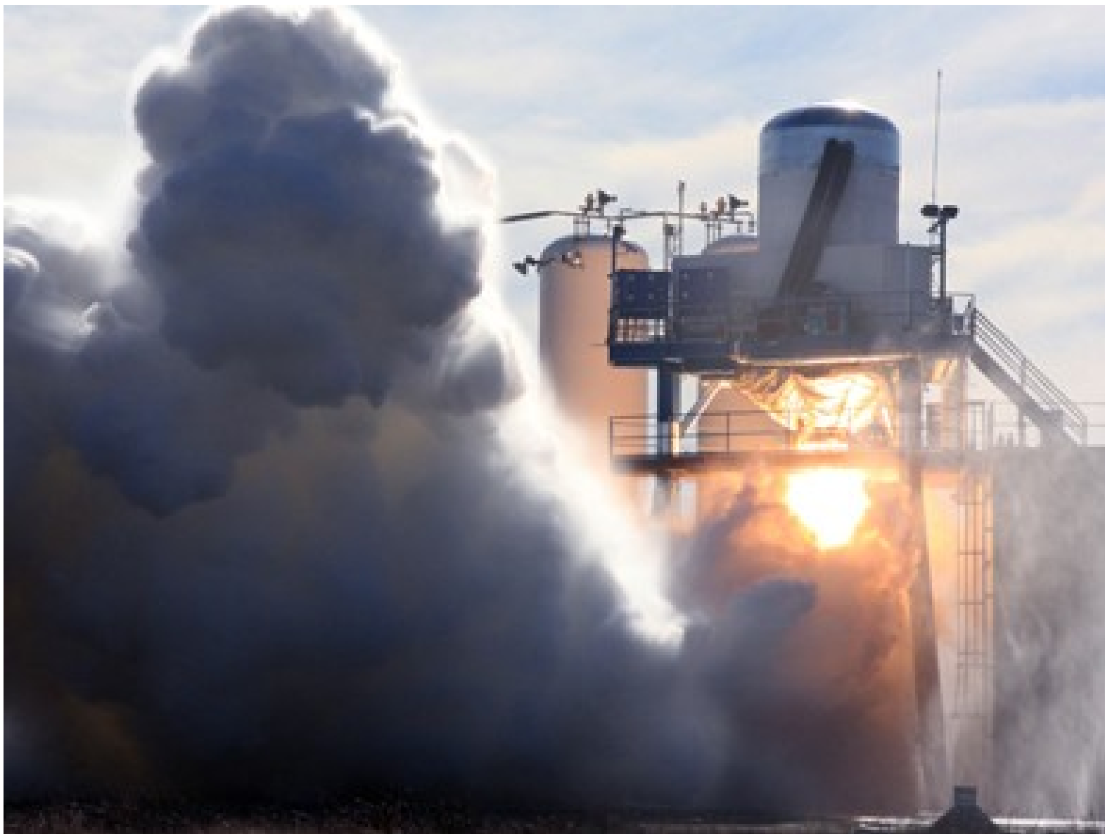
Zkouška motoru Merlin 2. stupně rakety Falcon 9 dne 2. 1. 2010 v trvání 5,5 min
